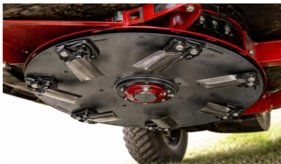
Şəkil 1. Rotasiyalı disk üzərində bıçaqların yerləşməsi
