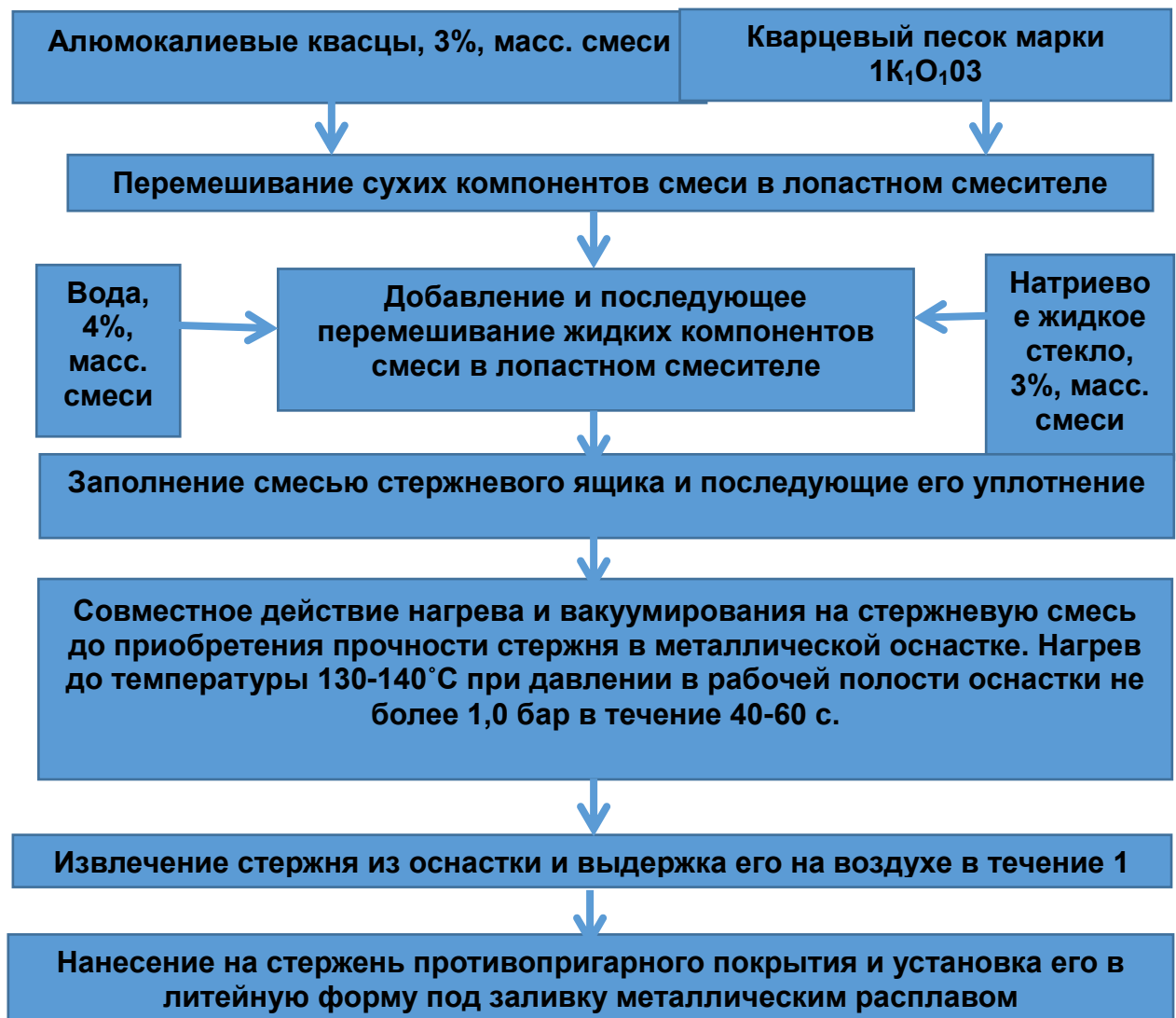
Рисунок.1. Блок-схема технологического процесса изготовления литейных стержней на основе комбинации неорганических солей
