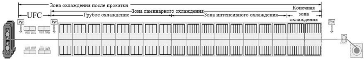
Рисунок 2-Размещение оборудования системы охлаждения после прокатки[2]
